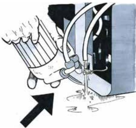
**3.A DESCONEXIÓN DE PORTA MEMBRANAS:** desconectar los tubos del porta membranas, presionando la sujeción del enlace rápido y abrir el porta membranas con su llave.
