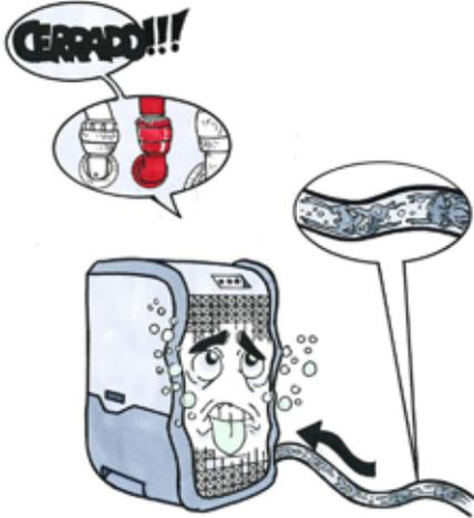
**¡El tubo de descarga de rechazo no puede estar bloqueado!**
